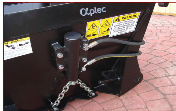
▲ Detalle sistema de descarga hidráulico. Detailed hydraulic discharging system.
