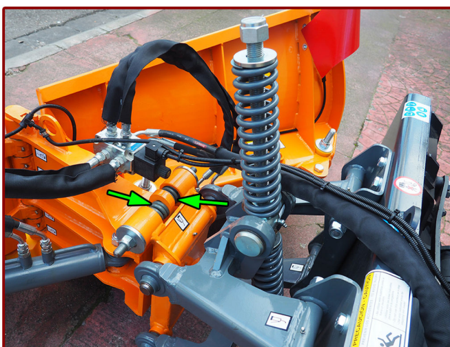
▲ Oscilación lateral con autonivelación y retorno por muelles. Lateral oscillation with self levelling and return by springs.
