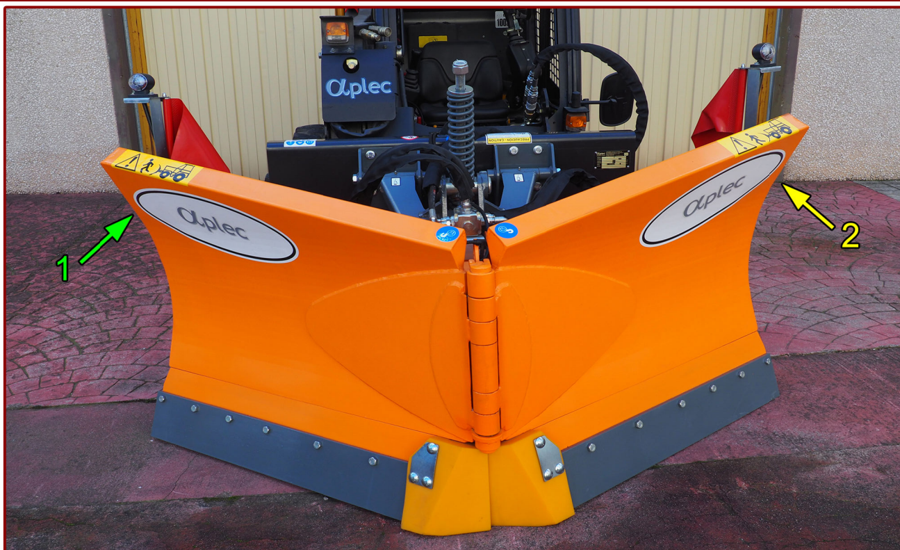
▲ Angulación horizontal hidráulica de las alas 1 y 2 independientes entre sí. Hydraulic horizontal angulation of the wings 1 and 2 independent of each other.
