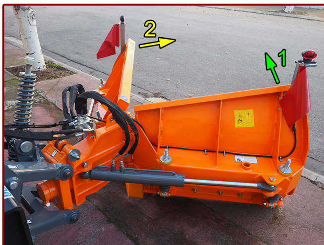
▲ Alas 1 y 2 anguladas totalmente hacia adelante. Wings 1 and 2 angled fully forward.
