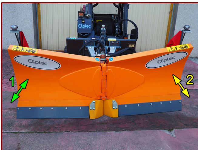
▲ Alas 1 y 2 anguladas parcialmente. Wings 1 and 2 angled partially.
