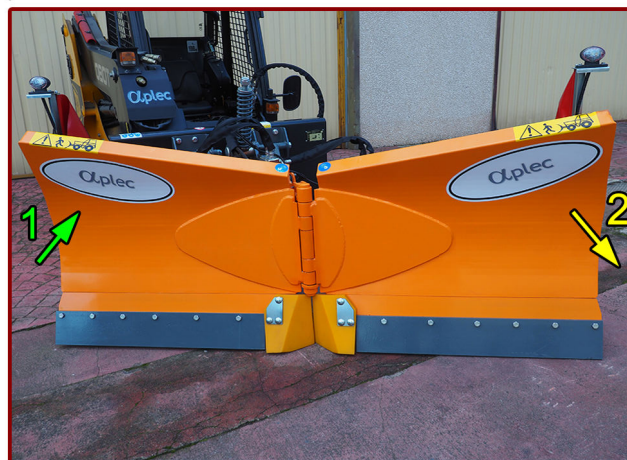
▲ Ala 1 angulada totalmente hacia atrás - Ala 2 angulada totalmente hacia adelante. Wing 1 angled fully back - Wing 2 angled fully forward.
