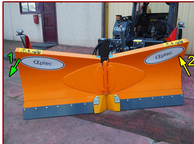
▲ Ala 1 angulada totalmente hacia adelante - Ala 2 angulada totalmente hacia atrás. Wing 1 angled fully forward - Wing 2 angled fully back.
