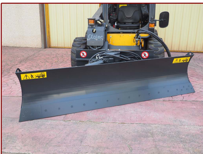
▲ Angulación horizontal hidráulica - izquierda Horizontal hydraulic angulation - left
