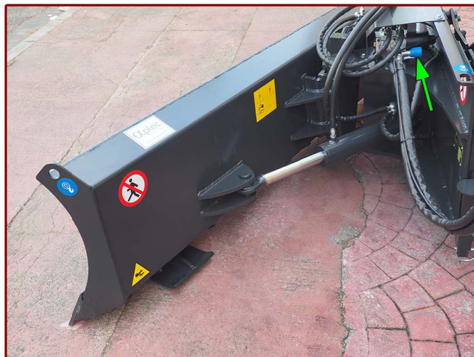
▲ Velocidad de movimientos ajustable Speed movements adjustable
