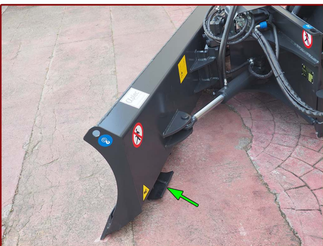
▲ Patines atornillados reemplazables Replaceable bolted skids
