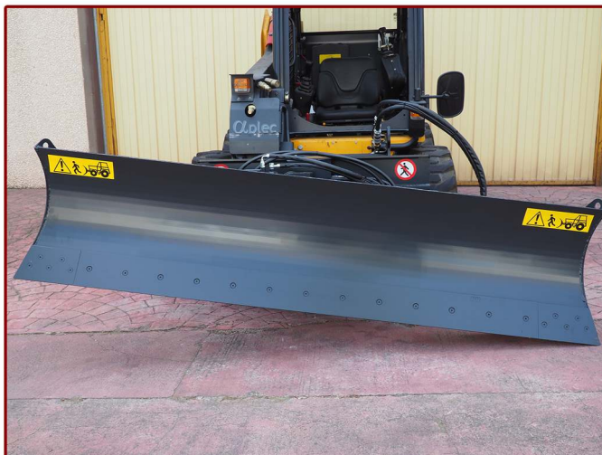
▲ Inclinación vertical hidráulica (derecha-izquierda) Vertical hydraulic tilt (right-left)
