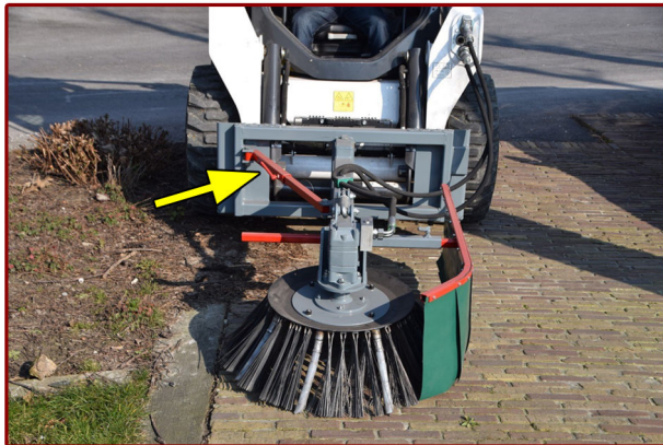
▲ Angulación horizontal del cepillo ajustable manualmente Manual adjustment of horizontal brush angle
