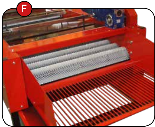
F. La schermata finale separa il resto della terra ed evita la sua introduzione nel bins.
