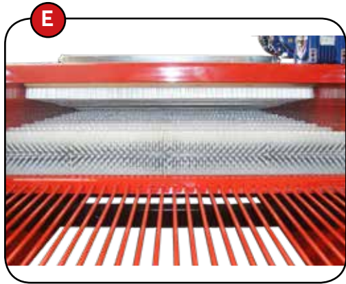
E. Gli speciali filamenti sintetici per l'aglio facilitano una rotazione esemplare dei bulbi e assicurano un'accurata pulizia senza danni.
