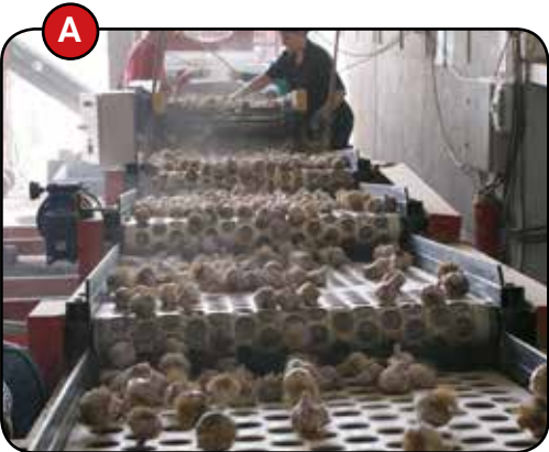
A. Modules en cascade. La conception modulaire des unités de classification permet de combiner autant de sections que sont souhaitées pour une plus grande gamme de qualités.
