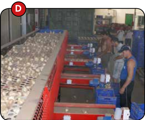
D. Conditions d’organisation optimales Chaque module a une sortie indépendante avec suffisamment d’espace pour le travailleur à l’inspection, au contrôle et à l’empilement.
