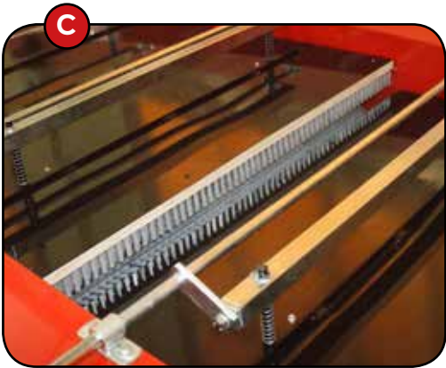
C. Deux panneaux de brossage supérieur avec double réglage permet d`ajuster l`intensité de travail.
