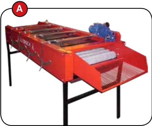
A. Il y a une surface de 3 mètres de brossage inférieur et supérieur. Enlève avec une grand efficacité la terre et des feuilles sales extérieurs.
