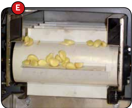
E. Efficacité de 98%. Le chauffage précédent avant l'égrenage et dans le tapis d'alimentation permet d'obtenir une grande efficacité de pelage.
