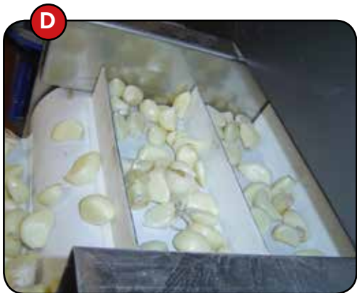
D. Construction de matériel d´usage alimentaire. Construite en acier inoxydable et PVC d´usage alimentaire selon les règles CE des machines pour la manipulation des aliments.
