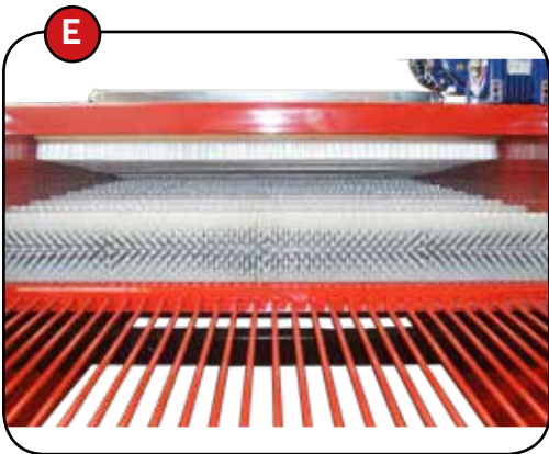
E. Les filaments synthétiques spéciaux pour l`ail facilitent une rotation exemplaire des bulbes et garantissent un nettoyage soigné sans dommage.
