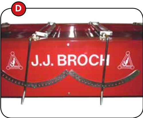
D. Contrôle facile de double réglage des panneaux de brossage supérieur.
