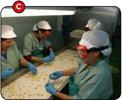
C. Tapis de contrôle et finition manuelle. Le tapis à la sortie de la chambre à air comprimé permet de faire l´inspection de produit épluché et enlever des caïeux de qualité basse.
