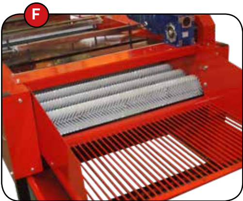
F. La grille finale sépare les restes de la terre de bulbes avant leur déchargement dans un conteneur.
