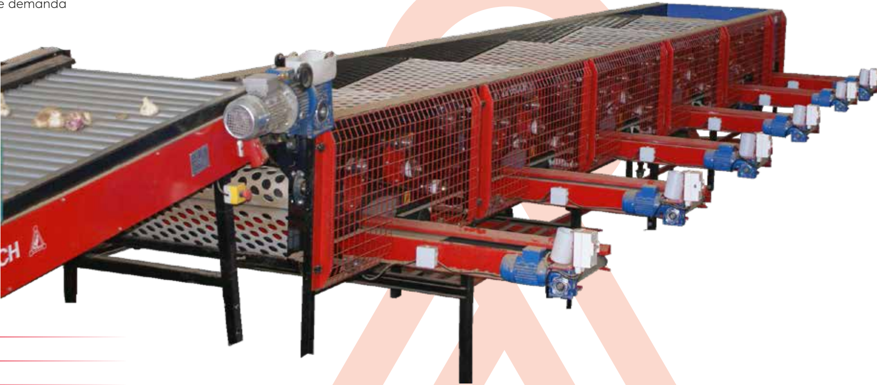
A. Módulos en cascada. El diseño modular de las unidades de clasificación permiten combinar tantas secciones como se quiera para un mayor rango de calidades.
