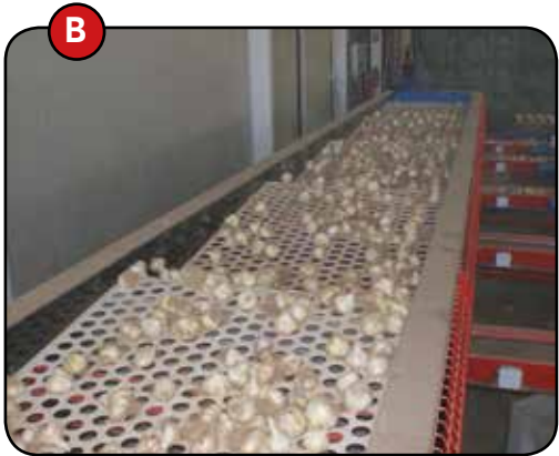
B. Calibrado preciso. La larga superficie de cada módulo y la regulación de la velocidad de cinta da el tiempo necesario para la exacta selección de cada bulbo en su calibre.
