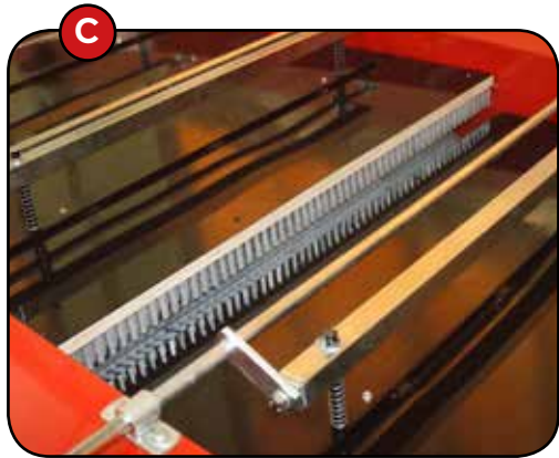
C. Dos placas de cepillado superior con doble regulacion permiten ajustar la intensidad del cepillado.
