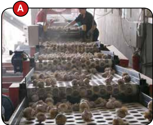
A. Módulos en cascada. El diseño modular de las unidades de clasificación permiten combinar tantas secciones como se quiera para un mayor rango de calidades.
