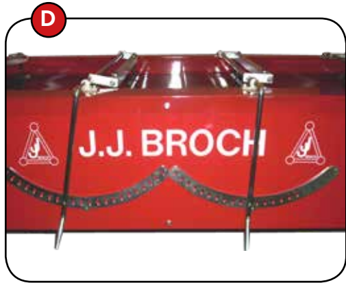
D. Fácil regulacion del doble ajuste de las planchas de cepillado superiores.
