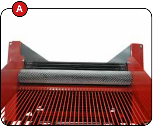
A. La combinación entre la cinta de varillas, el cepillo final y la parrilla de descarga separan y eliminan los restos de tierra de los bulbos facilitando el secado y almacenaje.
