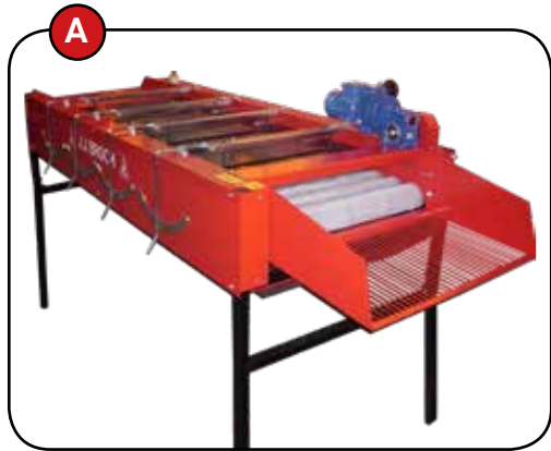
A. 3 metros de cepillado inferior y superior. Elimina de forma eficiente la tierra y las hojas externas coloreadas.
