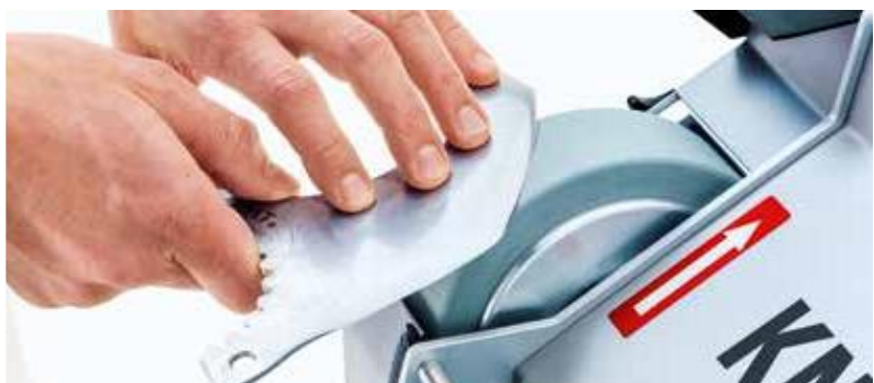
■ Cuchilla de cúter desbarbando con disco humedo
