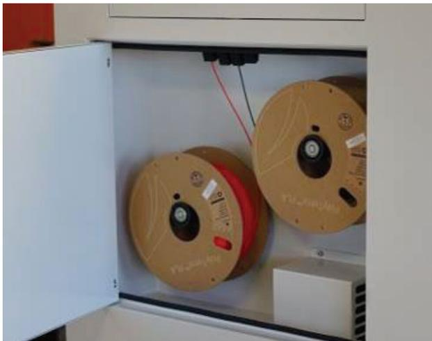
Control de humedad y temperatura del material
