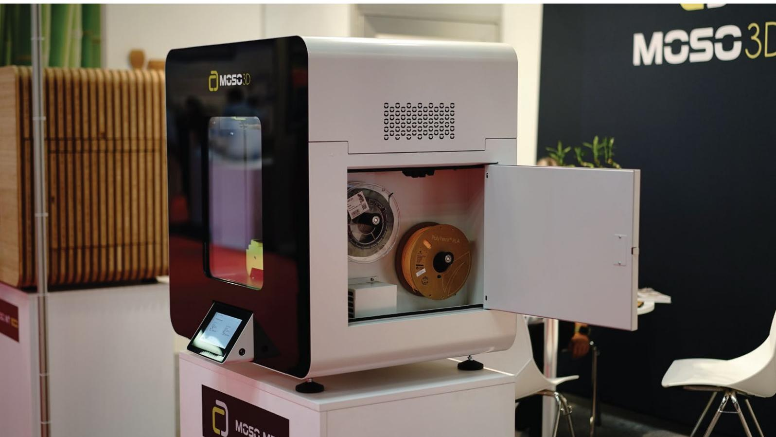
La impresora Moso MT mantiene en un alojamiento aislado los materiales. Controla automáticamente la humedad y temperatura de los materiales para imprimir sin fallos.
