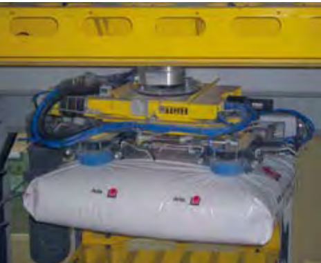
Pinzas robotizadas especiales adaptadas a cada aplicación
