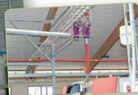
HD-transportadores espirales llenando alimentador del robot de ordeño
