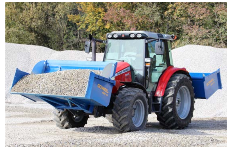
6) GHU 10 con equipamiento adicional «Dispositivo basculante» para trabajos de nivelado de superficies
