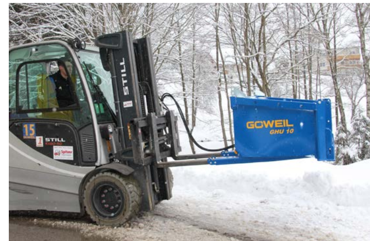
3) GHU 10 con montaje de carretilla elevadora
