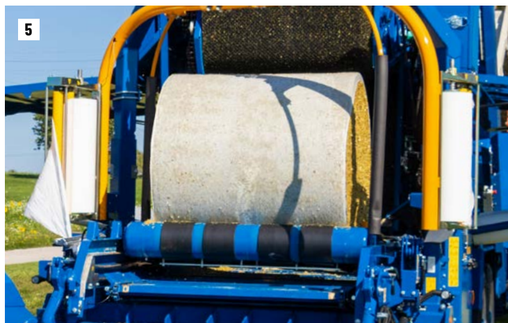
La paca es recogida por la mesa envolvedora desplazable
