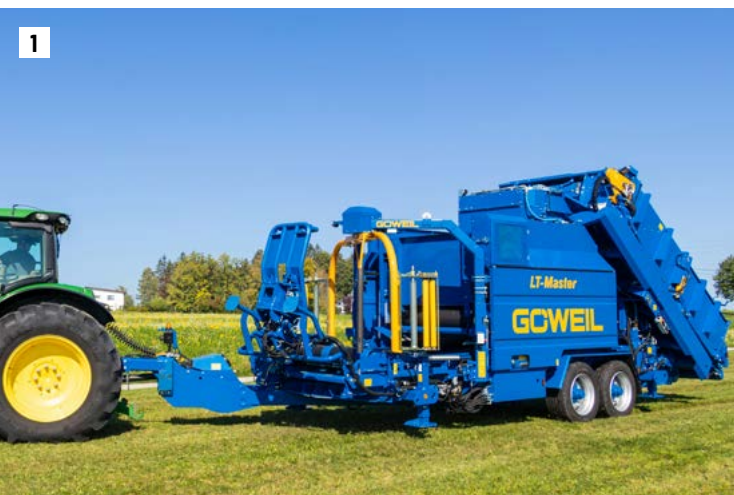
1 Posicionamiento correcto de la LT-Master y giro hacia fuera de la lanza
