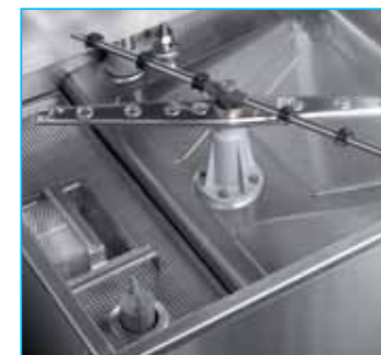
FI-80: Detalle del sistema de lavado y aclarado.
