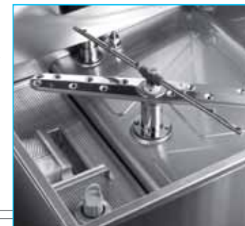
FI-100 y FI-120: Detalle del sistema de lavado y aclarado.
