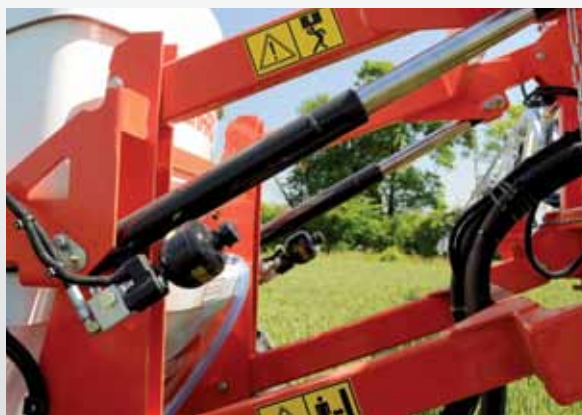
Cilindro del paralelogramo equipado con un acumulador de nitrógeno en la suspensión.
