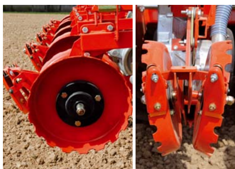
Rueda «V» de goma para cerrar los surcos en todo tipo de condiciones.
