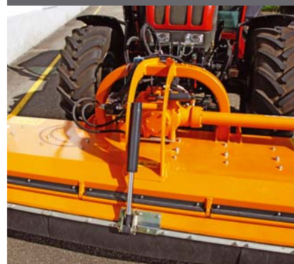
Cárter de doble sentido de rotación con cubierta e inversor hidráulicos
