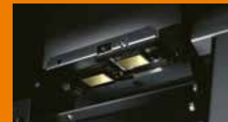
Dos cabezales de impresión dispuestos en escalera.
