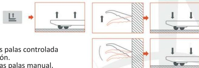
PTE15X Elevación de las palas controlada por el botón de elevación.
