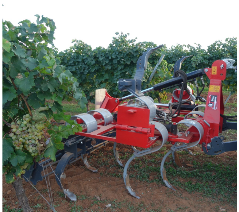
2 brazos curvos plegables y tripuntal hidráulico
