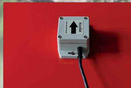
El sensor GPS en la tapa de la tolva es una opción para determinar la velocidad con precisión
