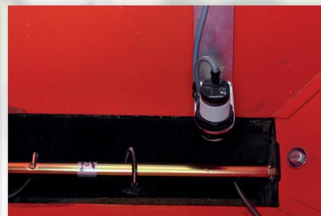
El sensor de nivel indica cuando queda poca semilla. El sensor funciona de forma inductiva y, por lo tanto, es independiente a las vibraciones
