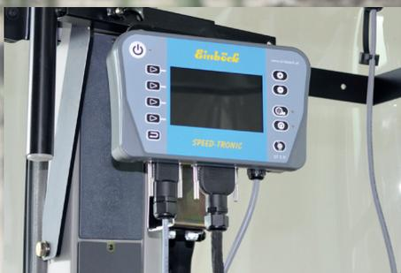
La energía se suministra a través de la electrónica de la cabina del tractor. Con la toma de señal de 7 pines, se pueden tomar los valores del sensor del tractor (por ejemplo, velocidad)
