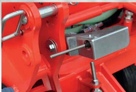
El sensor del mecanismo de elevación apaga automáticamente el rodillo de siembra cuando se levanta la máquina
