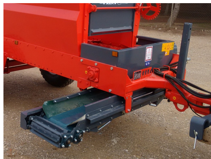
Cinta desplazable hidráulica a la derecha con rodillo lanzador (K-CI-01 + K-RO-01)
