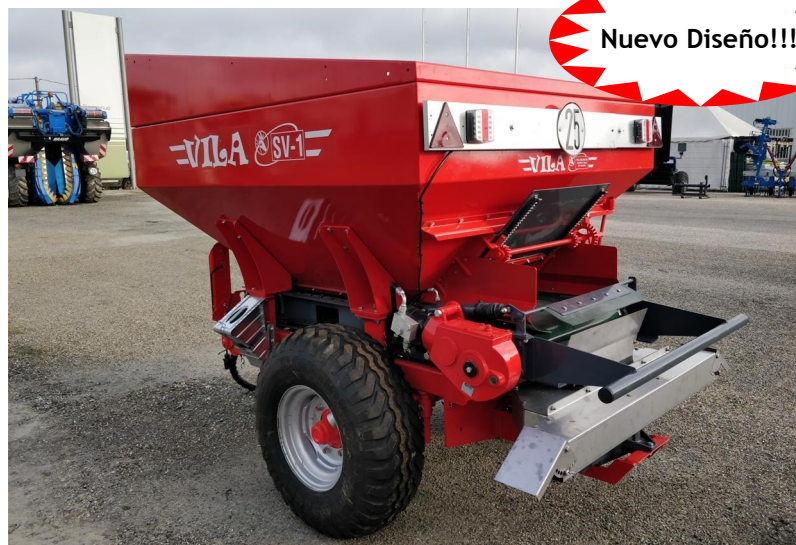
SV-1 con funcionamiento hidráulico y esparcidor de doble discos INOX (K-GD-01 + K-CA-01)
