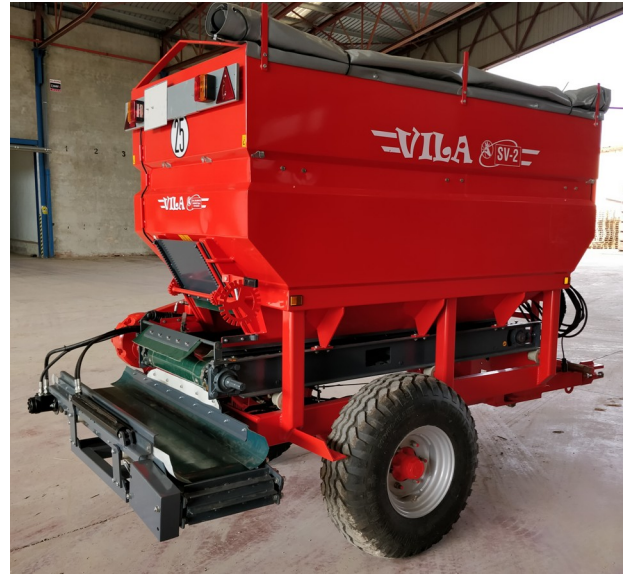
SV-2 MINI con cinta desplazable hidráulica a la derecha y rodillo lanzador fijo (K-SO-01 + K-CI-01 + K-RO-01)
