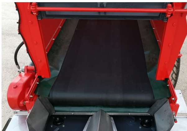
Con banda de goma Para abono granulado o mineral
