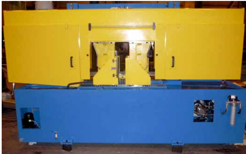
Arco recto y mordaza autocentrante d.máx 300 mm
