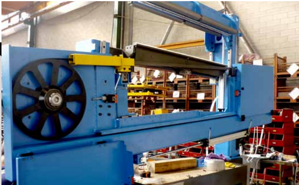
Corte paneles en resina 1250 x 300 mm alineamiento automático
