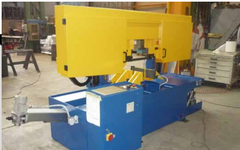
Arco recto y mordaza autocentrante d.máx 250 mm
