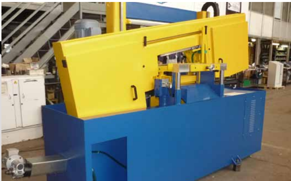
Arco inclinado 10° para corte múltiple
