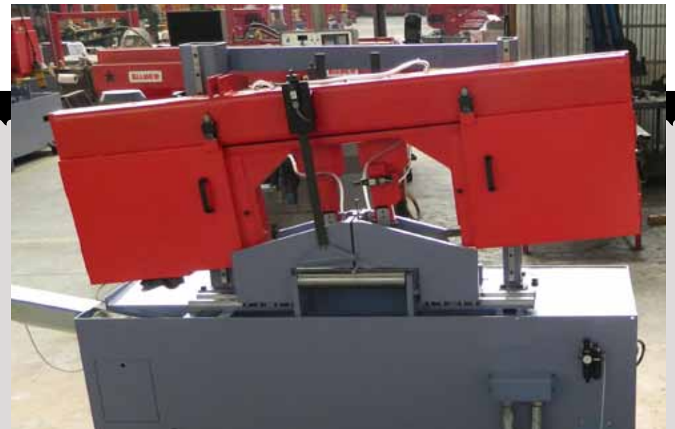
Corte barras con doble mordaza autocentrante
