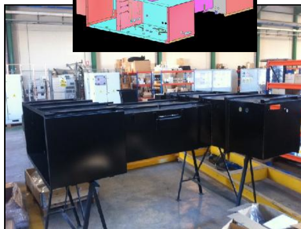
Estructura armarios locomotoras
