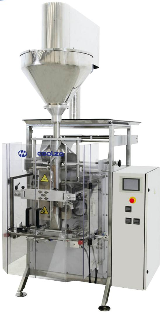
La máquina envasadora vertical Coalza de la serie **RS modelo DS**, está especialmente diseñada para la dosificación y envasado de **productos en polvo** tales como harina, leche en polvo, pimentón, café molido, gofio, cemento etc.
