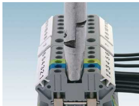
Dedo de prueba con diámetro de 12,5 mm
