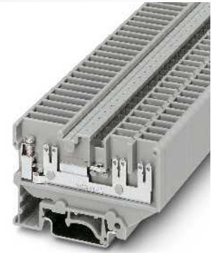
4 (4) mm 2 , 29 A, borne de paso, con conexión por tornillo y de enchufe plano
