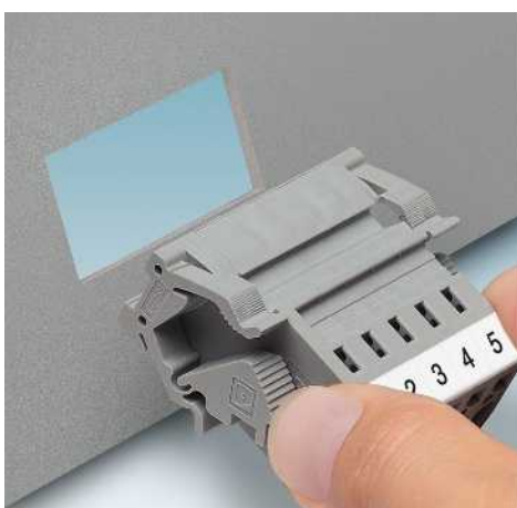
Montaje del acoplamiento y SSL 2,5 en el corte de la pared
