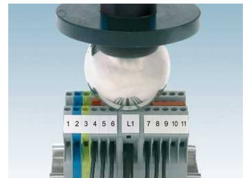
Dedo de prueba con diámetro de 50 mm
