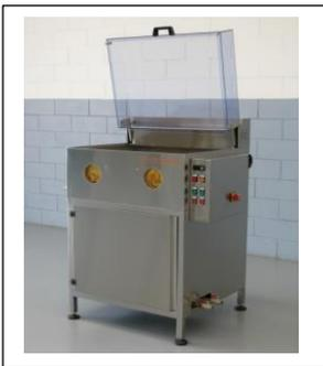
**Lavadora industrial con plataforma de rotación manual, íntegramente hecha de acero inoxidable Aisi 304 adecuada para una carga máxima de 100 Kg**
