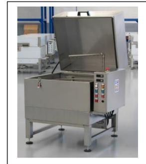
**Lavadora industrial por aspersion, monofásica, automática con tambor rotativo motorizado, hecho enteramente de acero inoxidable aisi 304 con estructura portante tubular adecuada para una carga máxima de 200 Kg.**
