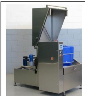
**Lavadora industrial por aspersion, bifásica, automática con tambor rotativo motorizado, enteramente hecha de acero inoxidable Aisi 304 con carga máxima de 400 Kg (cargas mayores a petición).**
