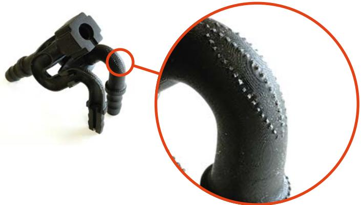
Cuando diseñe para cualquier tecnología de fabricación aditiva, debe tenerse en cuenta que las áreas con soportes no serán estéticamente perfectas. Tenga en cuenta al diseñar y orientar la pieza para minimizar la colocación del soporte.
