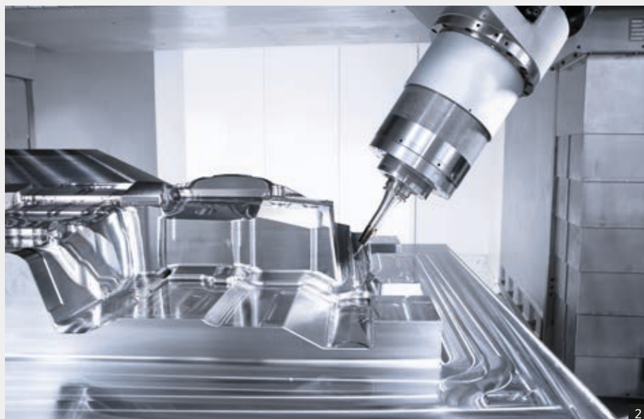
1: 5X torqueMASTER® – husillo de engranaje integrado en el eje B con un par de giro de 1.550 Nm 2: Acabado con husillo HSC-Pick-up intercambiable de 30.000 rpm 3: Desbastado de un molde para un tablero de instrumentos con el 5X torqueMASTER®
