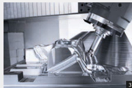
1: 5X torqueMASTER® – husillo de engranaje integrado en el eje B con un par de giro de 1.550 Nm 2: Acabado con husillo HSC-Pick-up intercambiable de 30.000 rpm 3: Desbastado de un molde para un tablero de instrumentos con el 5X torqueMASTER®
