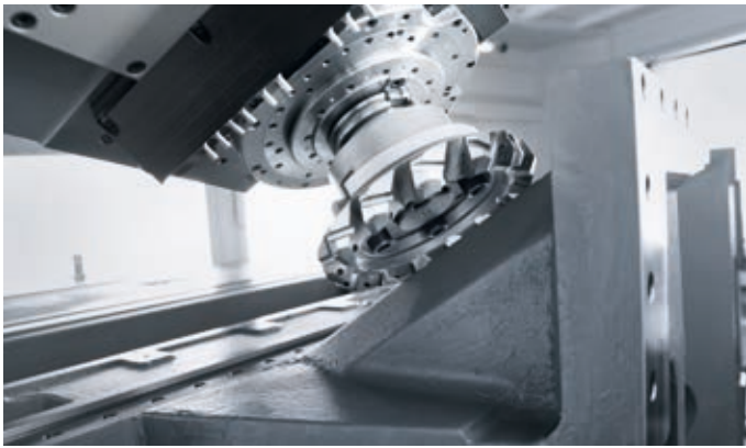
Husillo de engranaje SK50 / HSK-A100* 8.000 rpm / 28 kW / 727 Nm
