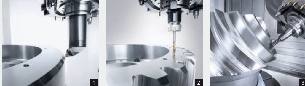
1: Torneado 2: Roscado 3: Fresado de rodadura con herramientas estándar
