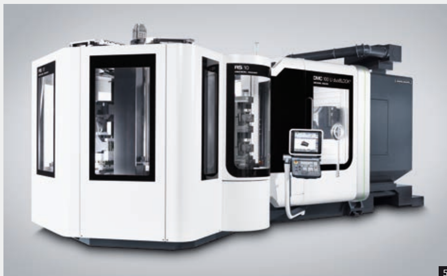
1: DMC U con almacén de palets diseñado como contenedor 2: Sistema de fabricación con tres centros de mecanizado, almacén lineal de 2 pisos con 52 puestos y almacén central de herramientas con 400 puestos 3: Célula de fabricación para componentes hidráulicos 4: Fabricación completamente automática de cajas de engranaje 5: DMC 100 U duoBLOCK® con almacén rotativo RS10 6: Almacén rotativo RS5
