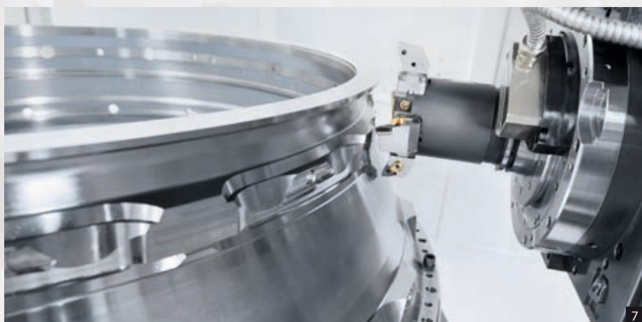
1: Torneado vertical con ejes A y B 2: Torneado horizontal con ejes A y B 3: Torneado con eje A y B accionado* 4: Medición de herramientas de torneado* 5: Medición de herramientas de fresado* 6: Ciclos de medición para la medición de la pieza durante el proceso de fabricación* 7: Aplicación de herramientas de múltiples filos cortantes (máx. 9) 8: Paquete para el rectificado
