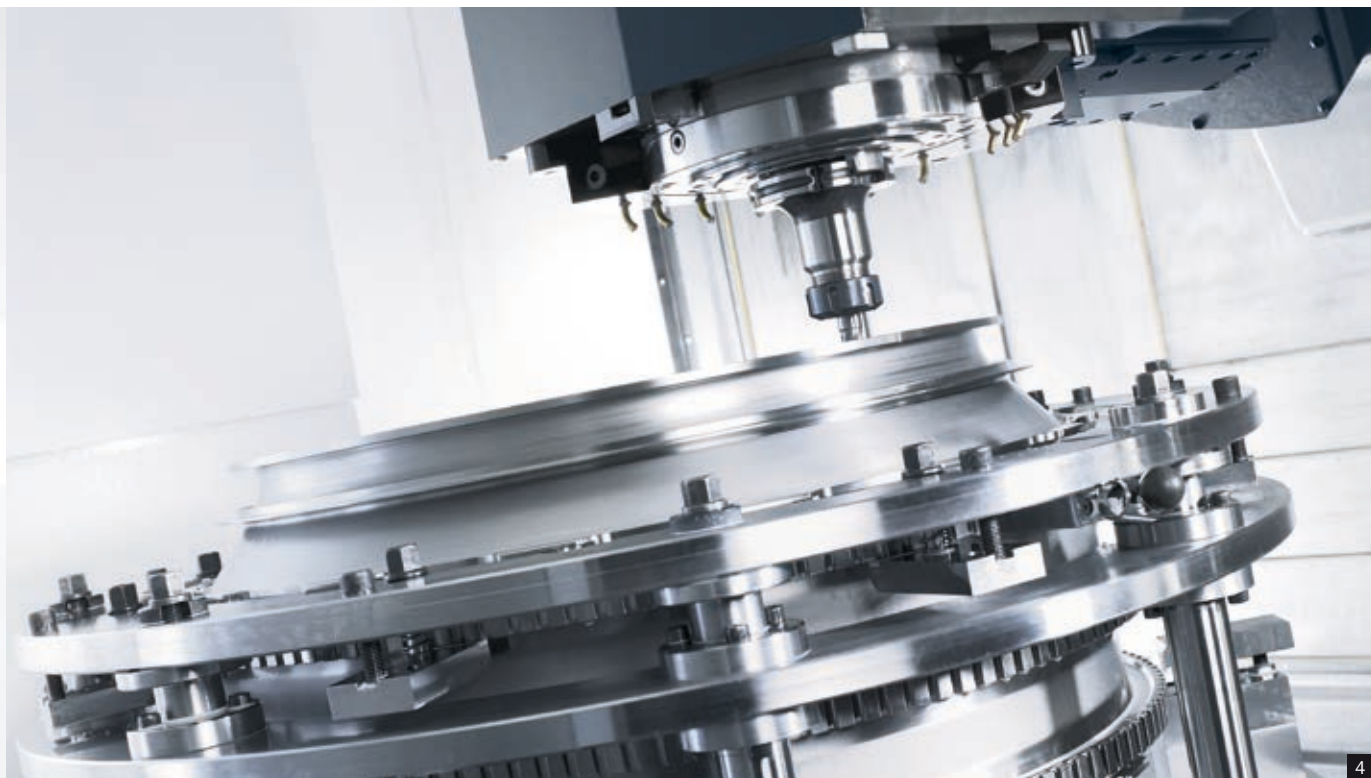
1: Caja de garras 2: Plato de amarre manual integrado 3: Plato de amarre hidráulico integrado 4: Mecanizado de fresado y torneado de una caja del compresor
