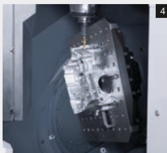
2-5: El enorme campo de basculación de la mesa rotativa basculante CN no deja nada que desear en cuanto al mecanizado completo
