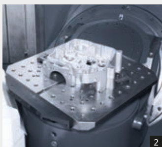
2-5: El enorme campo de basculación de la mesa rotativa basculante CN no deja nada que desear en cuanto al mecanizado completo
