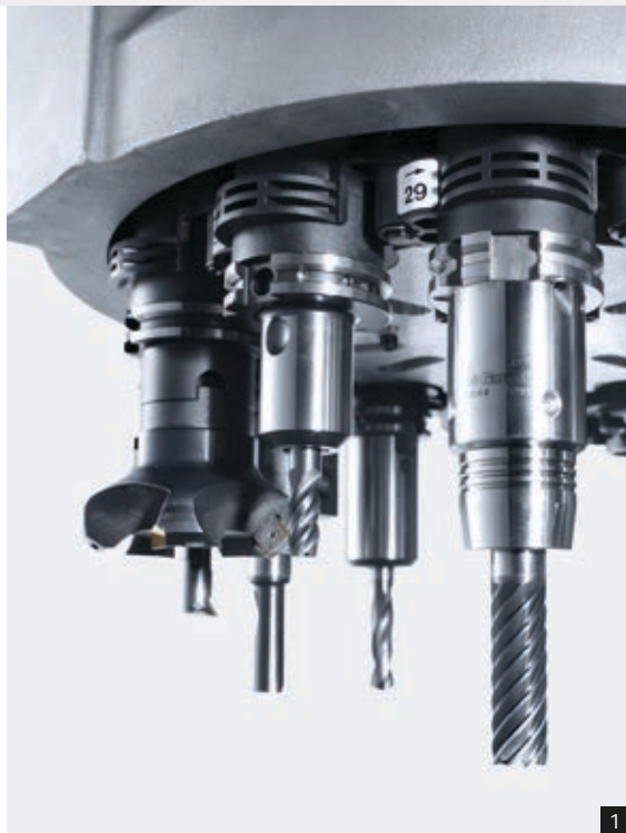
1: Almacén de herramientas equipable de manera simultánea al tiempo principal 2: Doble pinza para una rápida y segura transmisión de la herramienta 3: Opción: refrigeración interior 4: Husillo de 18.000 rpm para un mecanizado dinámico
