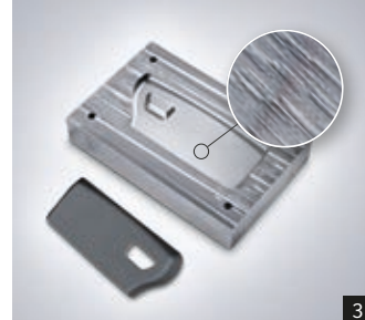
1: Integración flexible del cabezal de escaneo con láser vía interface HSK-A63 en el husillo 2: Texturización por láser de una estructura alveolar en un molde de inyección para una cubierta del volante 3: Molde de inyección para la tapa de una guantero con estructura de cuero
