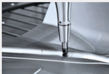
Molde para mangueras – dimensiones: 680 × 470 × 335 mm Tiempo de mecanizado: 4 horas 56 minutos, sujeciones: 2
