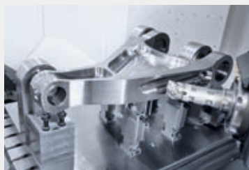
Componente del tren de aterrizaje – dimensiones: 1.080 × 610 × 210 mm Tiempo de mecanizado: 23 horas, sujeciones: 3
