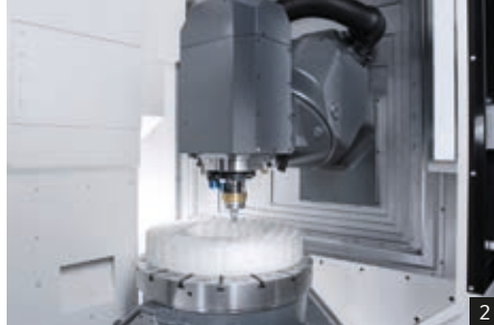
1: Rectificado de acabado de una carcasa para bombas de cuarzo de silicio químicamente resistente en una ULTRASONIC 125 FD duoBLOCK® 2: ULTRASONIC 60 FD duoBLOCK®: Estructuras de peso ligero y de paredes finas en el soporte del espejo de zerodur 3: Carcasa de nitruro de silicio para una cámara
