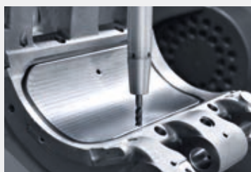
Portamoldes para fabricar botellas de PET– dimensiones: 400 × 360 × 400 mm Tiempo de mecanizado: 86 horas, sujeciones: 3
