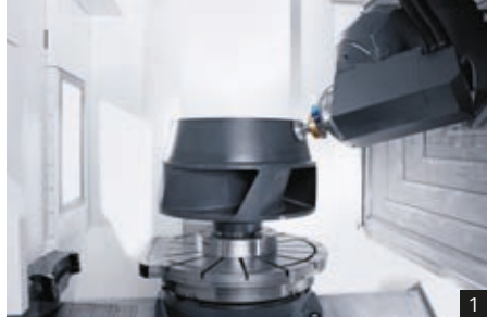
1: Rectificado de acabado de una carcasa para bombas de cuarzo de silicio químicamente resistente en una ULTRASONIC 125 FD duoBLOCK® 2: ULTRASONIC 60 FD duoBLOCK®: Estructuras de peso ligero y de paredes finas en el soporte del espejo de zerodur 3: Carcasa de nitruro de silicio para una cámara
