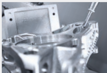
Muñón del eje – dimensiones (pieza bruta): 270 × 210 × 320 mm Tiempo de mecanizado: 24 horas, sujeciones: 3
