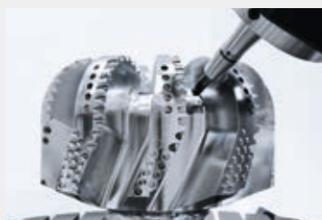
Cabezal de taladrado – dimensiones: 330 × 40 × 400 mm Tiempo de mecanizado: 18 horas, sujeciones: 1
