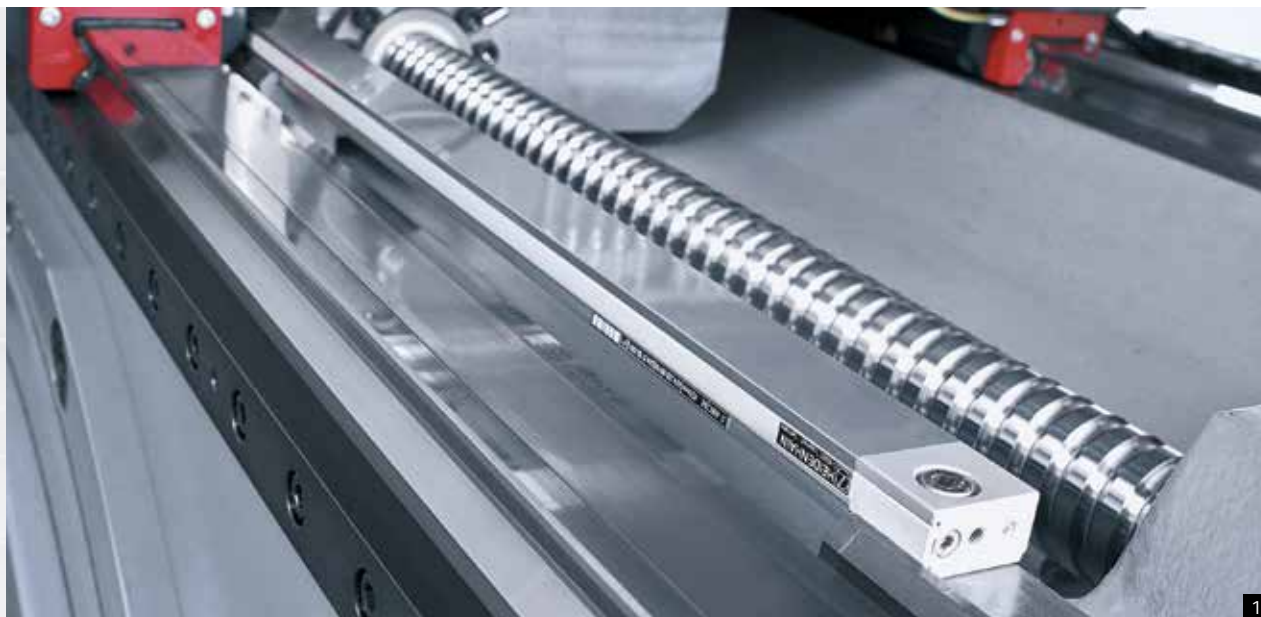
1: Accionamientos digitales, guías lineales y sistemas de medición directos (opción) para la máxima precisión 2: Mesa fija 3: Mesa rotativa basculante con accionamientos digitales 4: Mesa rotativa basculante para el mecanizado simultáneo en 5 ejes
