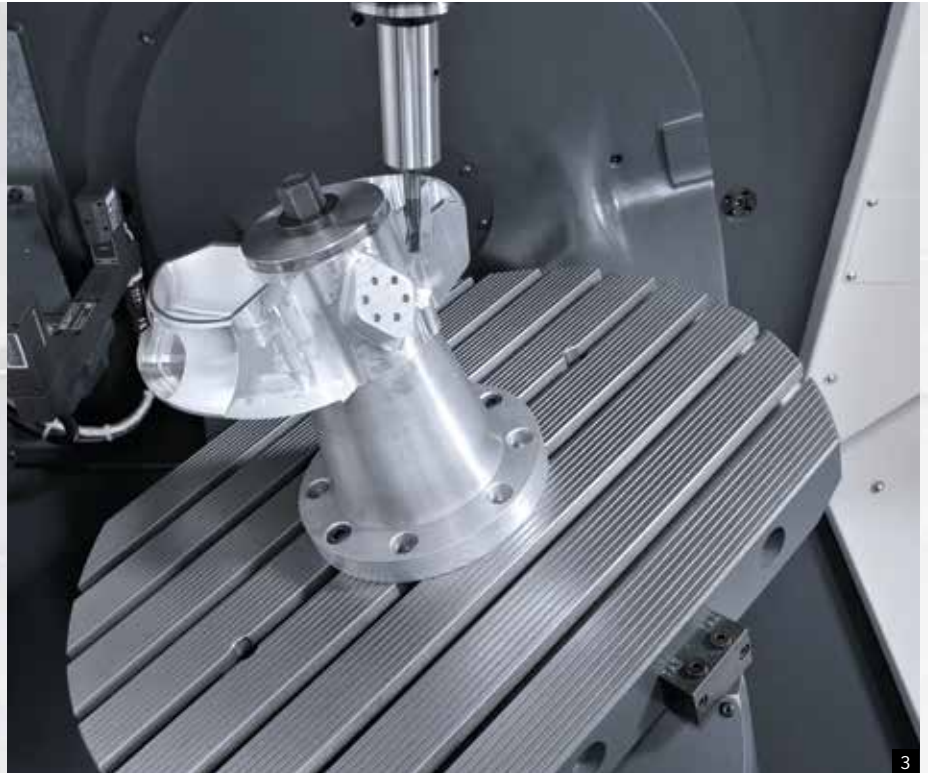
1: Mecanizado flexible con tres hasta cinco ejes 2: Área de mecanizado fácilmente visible, con almacén de herramientas opcional 3: Mesa para el mecanizado simultáneo
