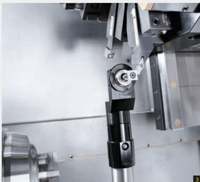
1: dispositivo de recolección de piezas (parte del paquete para el mecanizado de barras) 2: mecanizado con contrapunto y luneta (no disponible para ecoTurn 310) 3: sistema de medición de herramientas en el área de mecanizado
