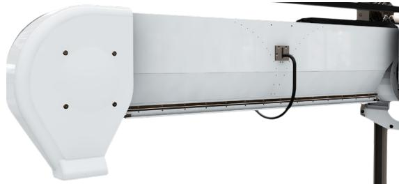
Secado de 152 kW (4 x 38 kW) con tobera horizontal copiante y deflector opcional para conseguir un mejor resultado en la parte trasera del vehículo. Como alternativa, se ofrece la posibilidad de incluir dos turboventiladores de 4 kW montados en la parte superior de la máquina para realizar el secado sin necesidad de escaneo.
