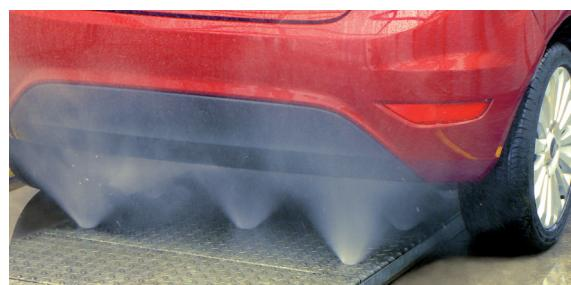
Se puede elegir entre lavado de bajos fijo 10 bar, 90 L/min, oscilante 15 bar, 120 L/min o por sectores 15 bar, 120 L/min.
