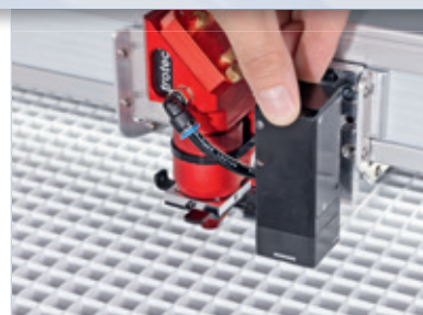
Sistema de cámara Print&Cut para materiales impresos
