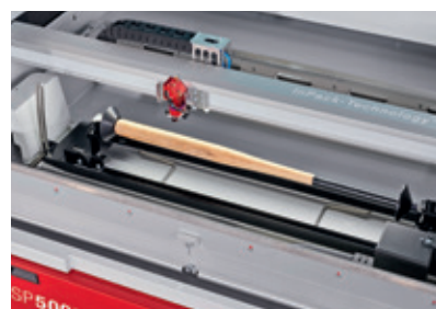
Grabado de objetos cilíndricos de hasta 1040mm de longitud.
