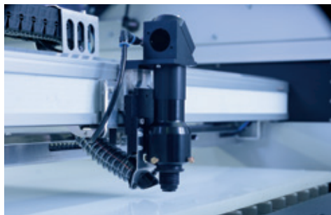
Extracción de partículas y gas simultánea al corte
