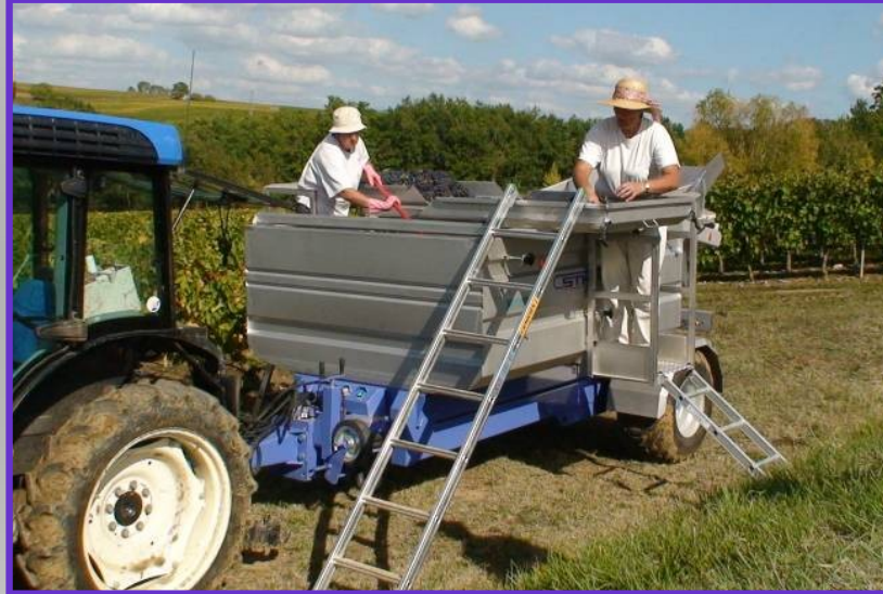
Mesa de Selección 100% Plegable con Barandillas de Seguridad
