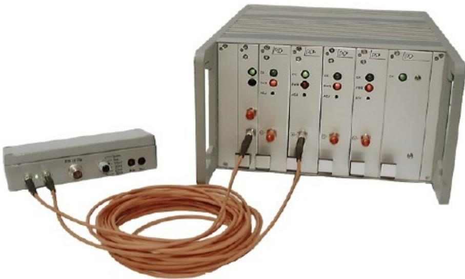
El FOsystem es un set completo de equipos para una buena transmisión vía fibra óptica de diferentes tipos de señales analógicas desde una serie de sensores. El FOsystem permite implementar una fácil transmisión vía fibra óptica para resolver los problemas del ruido, de seguridad y las cuestiones de la calidad de la señal en entornos de medida en alta tensión y en otras condiciones. El ancho de banda de la señal cubre hasta 10MHz.
