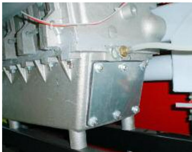
Inspección de la cuba de recogida de la condensación
