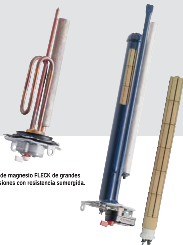
Ánodo de magnesio FLECK de grandes dimensiones con detalle de la resistencia de esteatita y vaina.
