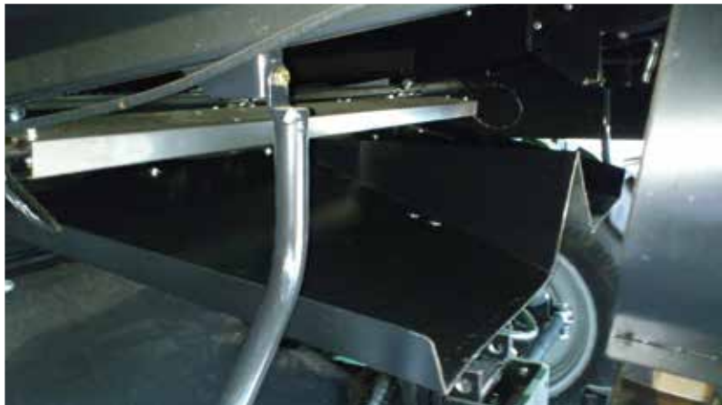
Nuevo transportador de granza con rampas metálicas que canalizan la granza hacia los rotores de cuatro álabes.
