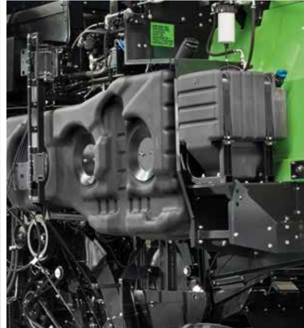
Depósitos de combustible y de AdBlue® de polietileno de 10 mm de espesor.
