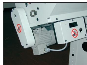
La motorizzazione è garantita da un motore asincrono per il caricamento della barra e da un motore brushless per l'avanzamento.
