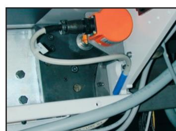
L'avanzamento della barra è controllato da un encoder.
