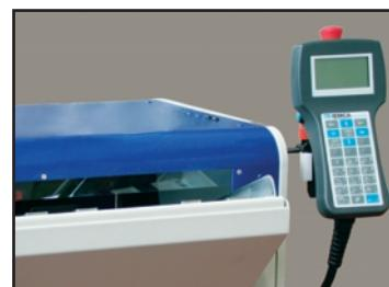
Il pannello operatore permette di gestire facilmente la programmazione del caricatore.
