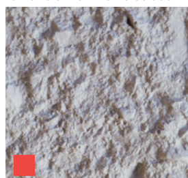
CSP-8 FRESADO MEDIO/PROFUNDO O FRESADO CON PICAS LIGERO
