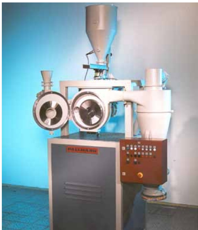
Sistema de pulverización con PM 300
