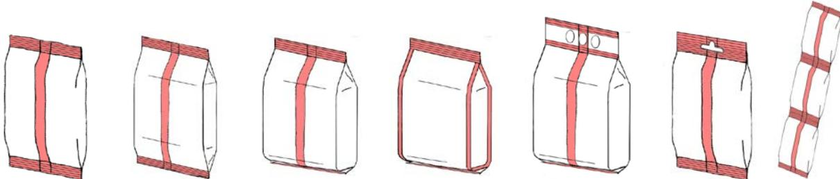
Bolsa almohada, bolsa con pliegue lateral, bolsa con fondo plano, bolsa con soldaduras laterales, bolsas con asas o displays, ristras.
