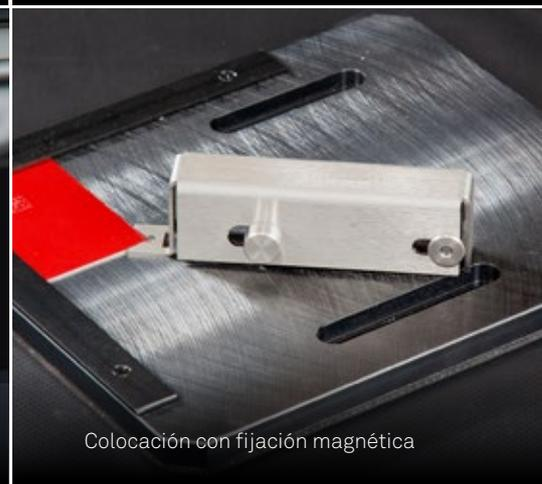
Colocación con fijación magnética
