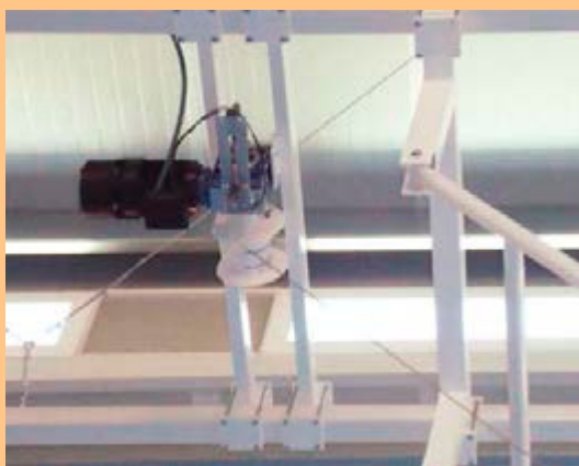
Motor reductor con freno y finales de carrera.
