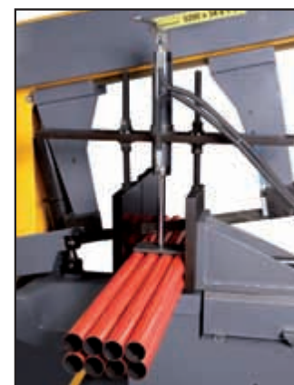
Pisador vertical hidráulico para paquetes
