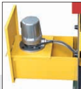
Bomba refrigeración en cajón independiente
