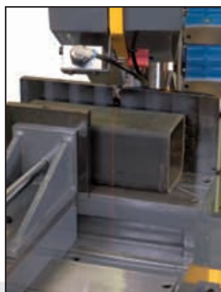
Láser marcador de la línea de corte
