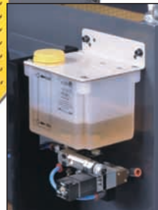
Lubricación Aire-Aceite Micropulverizado.
