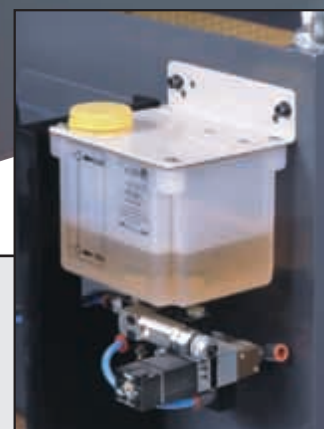
Lubricación Aire-Aceite Micropulverizado.
