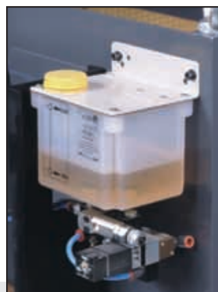
Lubricación Aire-Aceite Micropulverizado.
