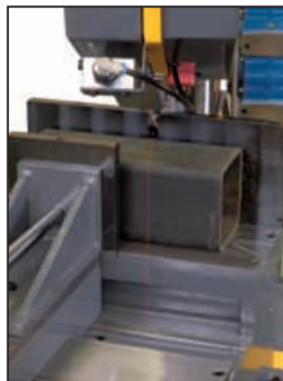
Láser marcador de la línea de corte
