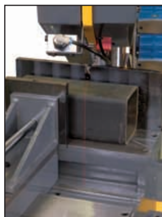
Láser marcador de la línea de corte
