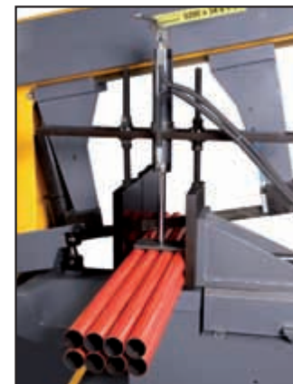
Pisador vertical hidráulico para paquetes
